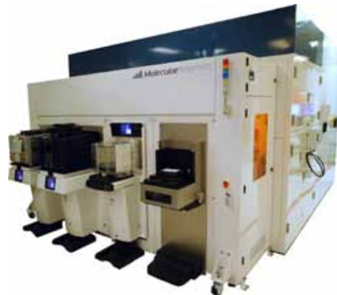
Рис. 3. Аппарат для нанесения фотолитографии
